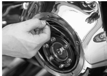
'04年以前のモデルは、ダービーカバーを外した時にバックンが溝にきちんと収まっているかを確認する。劣化している場合は即交換。
