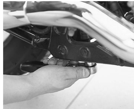
エンジンオイルのドレンプラグの先端には磁石が取り付けられており、鉄粉などが付着しているのでもきれいには洗浄する。ドレンボルトを締め込む際はオーパートルクは厳禁。
