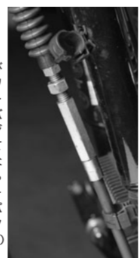
クラッチレバーの遊びの点検は、クラッチレバーとホルダーの隙間を測定して行う。フリーの状態を0（ゼロ）として、指で軽く握った時に2〜3ミリの隙間ができれば規定値内となる。
