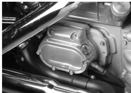
トランスミッションオイルはカバーの給油口から注ぐ。六角レンチでフィルタープラグを外すと、ディップスティックがついている。
