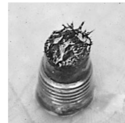
ドレンボルトは先端が磁石になっており、鉄粉は洗浄する。ドレンボルトはテーパになっており、オーパートルクは厳禁。オイルがにじむようならシールテープを巻くと良い。
