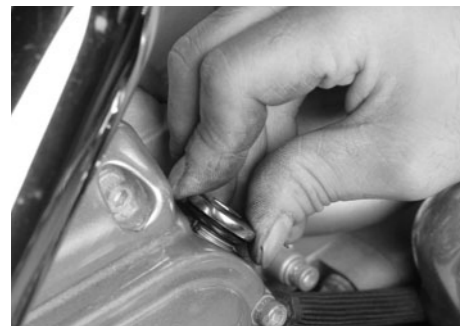
油面のチェック時は車体を水平にした状態で行う。ディップスティックはねじ込まないでカバーのネジ穴に触れた時点で引き抜く。
