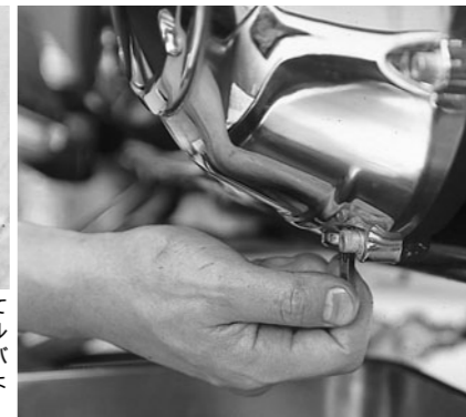
ドレンボルトは先端が磁石になっており、鉄粉は洗浄する。ドレンボルトはテーパになっており、オーパートルクは厳禁。オイルがにじむようならシールテープを巻くと良い。
