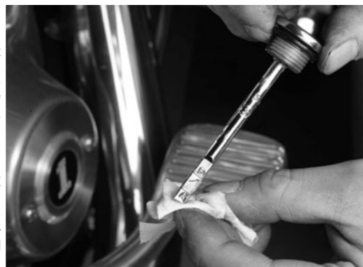
トランスミッションオイルはカバーの給油口から注ぐ。六角レンチでフィルタープラグを外すと、ディップスティックがついている。
