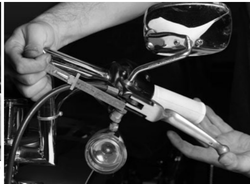
クラッチレバーの遊びの点検は、クラッチレバーとホルダーの隙間を測定して行う。フリーの状態を0（ゼロ）として、指で軽く握った時に2〜3ミリの隙間ができれば規定値内となる。
