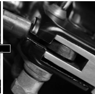
クラッチレバーの遊びの点検は、クラッチレバーとホルダーの隙間を測定して行う。フリーの状態を0（ゼロ）として、指で軽く握った時に2〜3ミリの隙間ができれば規定値内となる。
