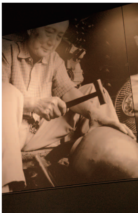
鋳起銅器の製造作業。1個の銅の固まりを打ち延ばしながら焼きなましを繰り返し、継ぎ目のない器を仕上げている鍛金技術のひとつ。
