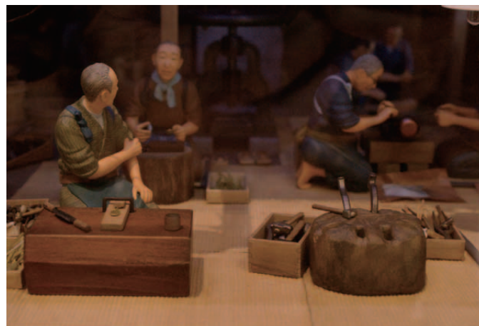
金属洋食器生産の創生期、燕の伝統工芸のひとつでもある「鋳起（ついき）銅器」の工房でスプーンを作っている様子。工房は間仕切りのない一室使用で、当時のイメージを極力再現したもの。
