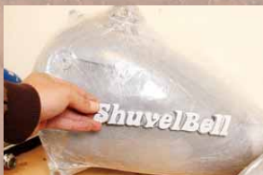
FLに用意した新たなタンクにはオリジナルエンブレムをアルミの削りでワンオフ製作。「ShuvelBell」とは彼のオリジナルブランド。
