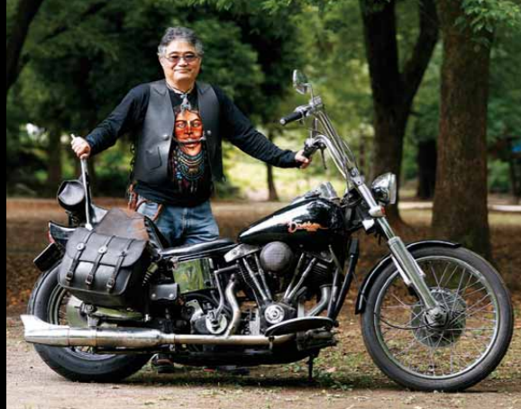
バッグ前部（下）の留め部分はマジックテープ付の革ベルトでサスペンションに、後部（下）は革ヒモでウインカーステーに固定させる仕組み。
