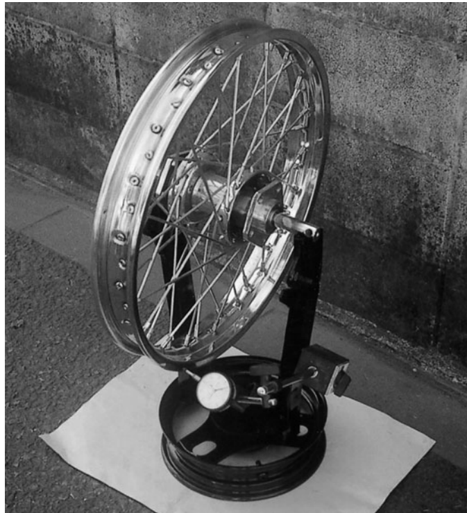
不用なスイングアームと原チャリ用ホイールを使って自作した振れ取り台。これにダイヤルゲージや針金をセットすればOK。
